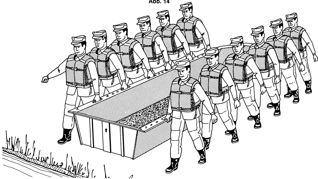
Zuwasserbringen eines Leichtmetall-Halbpontons durch 12 Helfer
