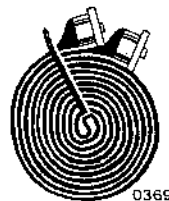
Druckschlauch zusammengerollt mit Rollschlauchriemen
